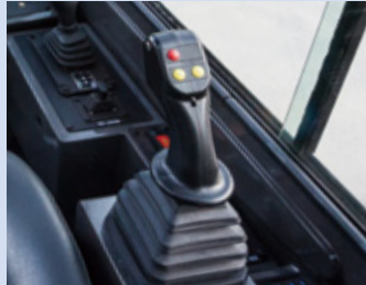
조작이 편한 (+) 형 조이스틱 원치 동작 감지(진동 전달) 시스템
